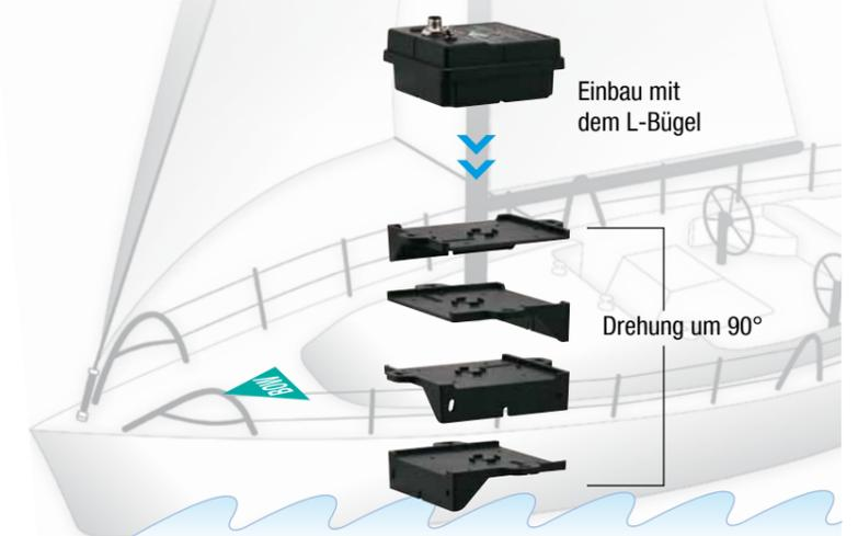
\*Da der L-Bügel um 90° gedreht werden kann, ist es möglich den PG-700 immer in Richtung des Bugs zu orientieren.
